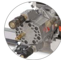
Hoofdmotor met aansluiting voor lekolie
